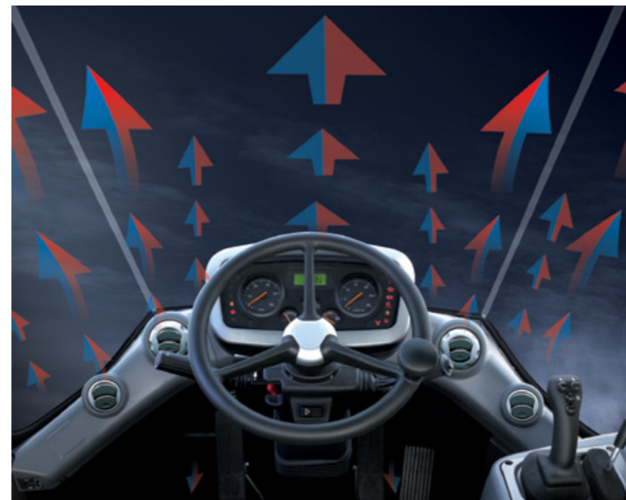
Система кондиционирования воздуха и обогрева стекол Двойная очистка воздуха в кабине, рациональное размещение в кабине воздуховодов и пропорциональные органы управления обеспечивают комфорт на уровне легкового автомобиля.
