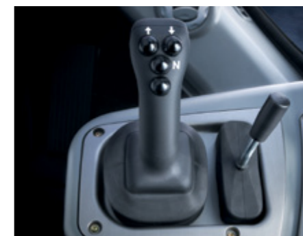
Многофункциональный рычаг управления Установленный джойстик позволяет сочетать управление рукояткой и ковшом, а также трансмиссией (с учетом предпочтений оператора могут поставляться другие варианты рычагов).
