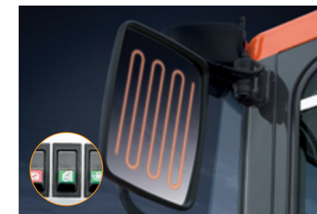
Наружные зеркала с подогревом в стандартной комплектации Наружные зеркала с подогревом обеспечивают хороший задний обзор даже в холодных и влажных условиях.
