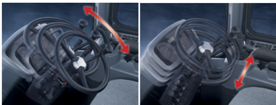
Рулевая колонка позволяет оператору работать более комфортно. Рулевая колонка с функциями наклона и телескопической регулировки.
