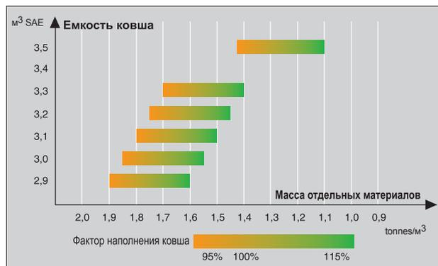
Фактор заполнения ковша также зависит от типа материала, рабочих условий и опыта оператора.
