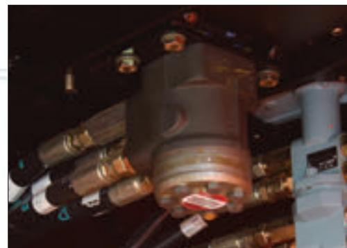
❖ **Рулевое управление с электронным гидравлическим усилителем**
