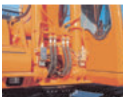
Клапан защиты от разрыва шлангов стрелы и рукояти
