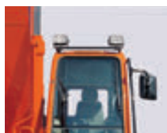
Дополнительные рабочие фары на кабине
