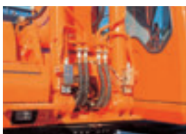
Клапан защиты от разрыва шлангов стрелы и рукояти
